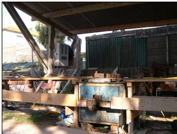
Figura 13 – Telheiro para corte/moldagem de ferro
